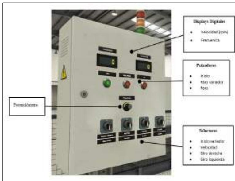
**Ilustración 15-4:** Tablero de la estación de sellado de cajas.
