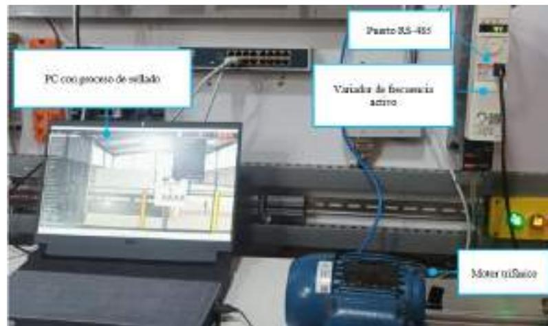
Se observa en la ilustración siguiente el display del modelado en Factory mostrando una frecuencia de velocidad de 19 Hz y en el variador de 19.1 Hz, diferenciándose en los decimales debido al truncamiento realizado en la programación del PLC.
