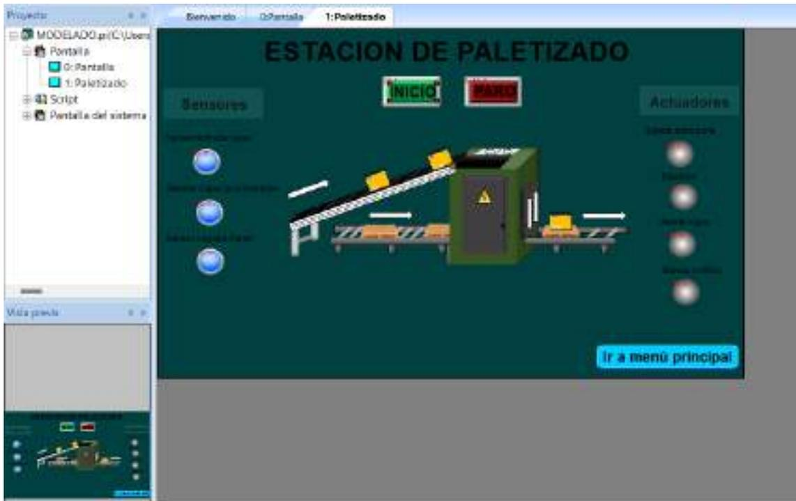
Para la asignación de un interruptor de bit a una entrada o salida tomando en cuenta la tabla 16-4 de la guía de práctica 6 que indica las I/O que se enviarán a visualizar en la pantalla HMI, se especifica a manera de ejemplo con la configuración del botón INICIO.
