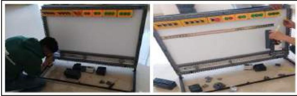
**Ilustración 31-3:** Montaje de riel DIN
