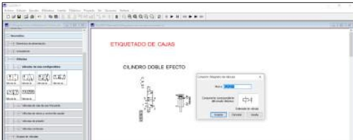
A continuación, empezamos a seguir realizando las configuraciones de la válvula para lo cual damos doble click en el punto 5 que son las salidas puerto de escape y vamos agregar salida de aire de la misma forma se realiza en el punto 3.
