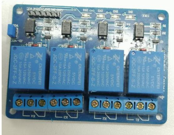
**Ilustración 16-3:** Módulo relé 4 canales
