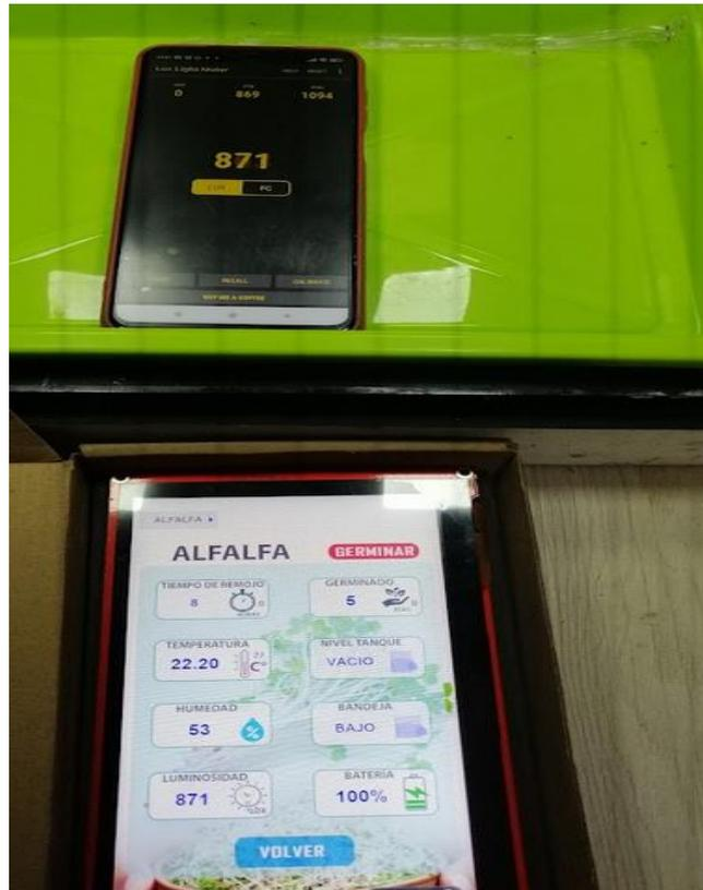
**Ilustración 4-4:** Evidencia de muestra tomada por la app móvil Lux Light Meter Pro y el sensor BH1750 del Germinador PRO
