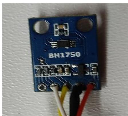
**Ilustración 7-3:** Sensor de luz digital BH1750
