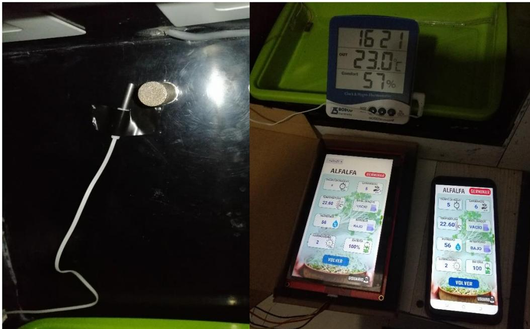
**Ilustración 3-4:** Evidencia de muestra del equipo patrón BOECO Germany BOE-327 y el sensor FS200-STH1 del Germinador PRO
