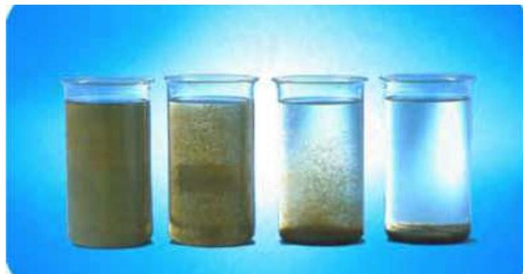
**Ilustración 5-2:** Proceso de sedimentación
