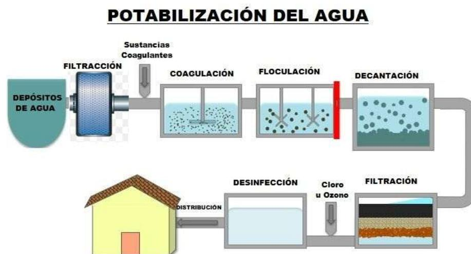
**Ilustración 7-2:** Proceso de potabilización del agua
