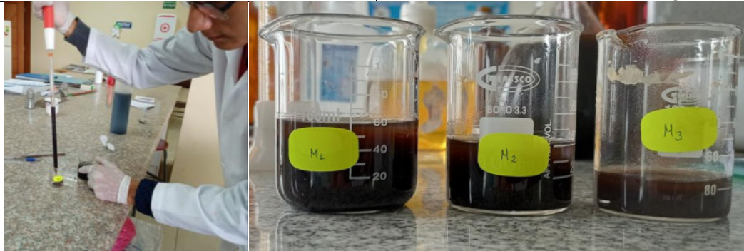
Soluciones con diferente porcentaje de coagulante – floculante natural y NPMs
