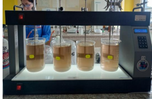
UE en el equipo de Prueba de Jarras a 20 revoluciones por minuto por 30 minutos
