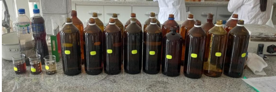
Muestras preparadas y soluciones coagulantes listas para los ensayos en el equipo Prueba de Jarras
