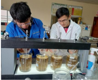
Agregado de la solución coagulante a las UE
