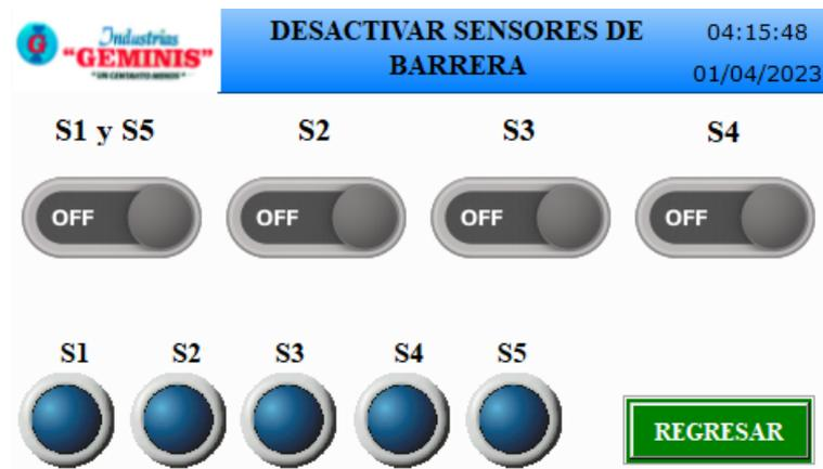
**Figura 67-3:** Panel para la desactivación de los sensores de barrera
