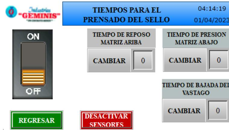
**Figura 66-3:** Panel de calibración de los tiempos de trabajo
