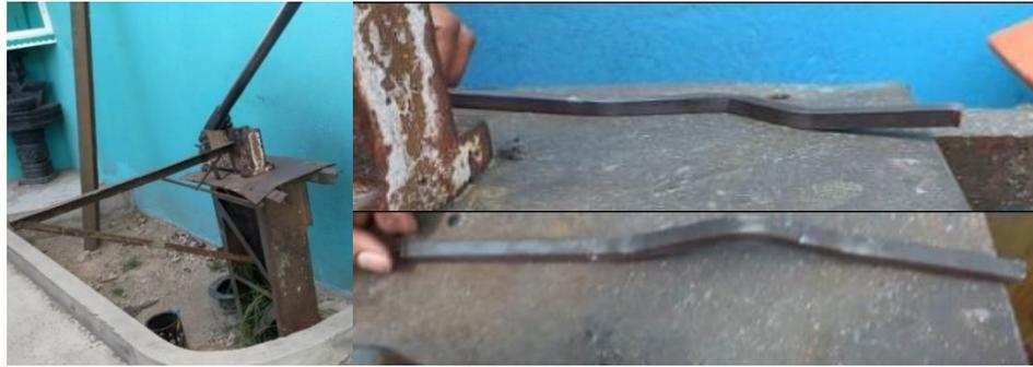
**Figura 2-3:** Dobladora de varillas manual de palanca
