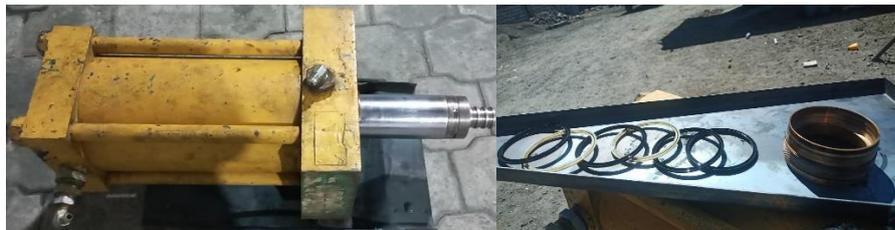
**Figura 39-3:** Desmontaje y cambio del kit de retenes del anillo guardapolvo
