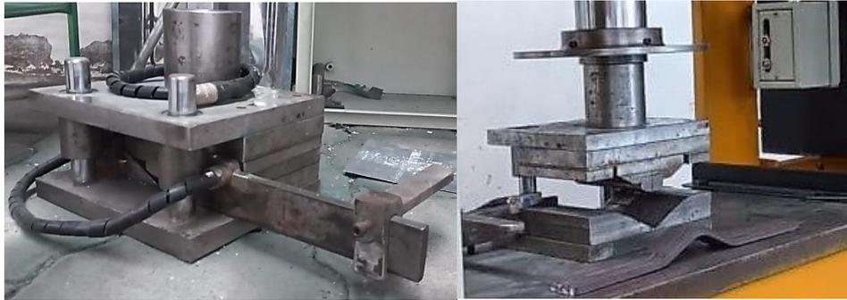
**Figura 51-3:** Sensor para la detección de las Varillas al interior de la matriz
