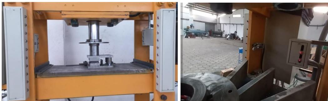
**Figura 48-3:** Montaje de los sensores de posición y barrera de seguridad
