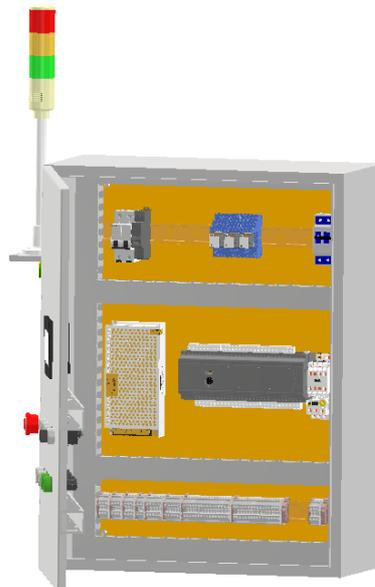
**Figura 31-3:** Diseño 3D del tablero eléctrico
