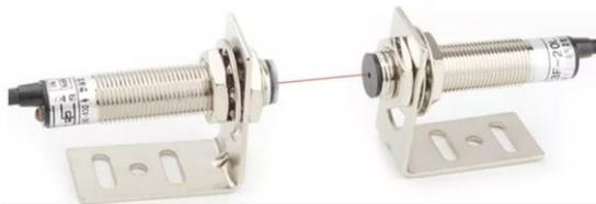
**Figura 10-3:** Sensor óptico E3F-20C1
