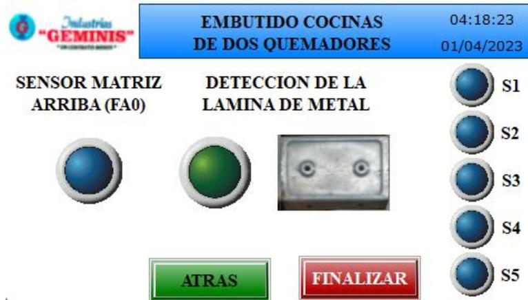
**Figura 70-3:** Panel de visualización de activación de sensores
