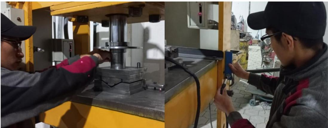
Selección el tipo y modo de trabajo para el doblado de varillas en el HMI
