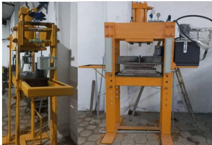
**Figura 46-3:** Presentación de la prensa electrohidráulica
