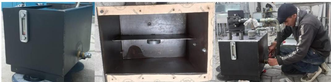
**Figura 42-3:** Limpieza, reparación y comprobación de fugas del tanque de aceite
