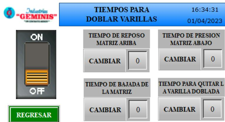
**Figura 75-3:** Menú de calibración de tiempos para doblar las varillas
