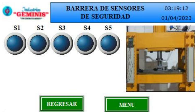
**Figura 61-3:** Panel de la barrera de seguridad
