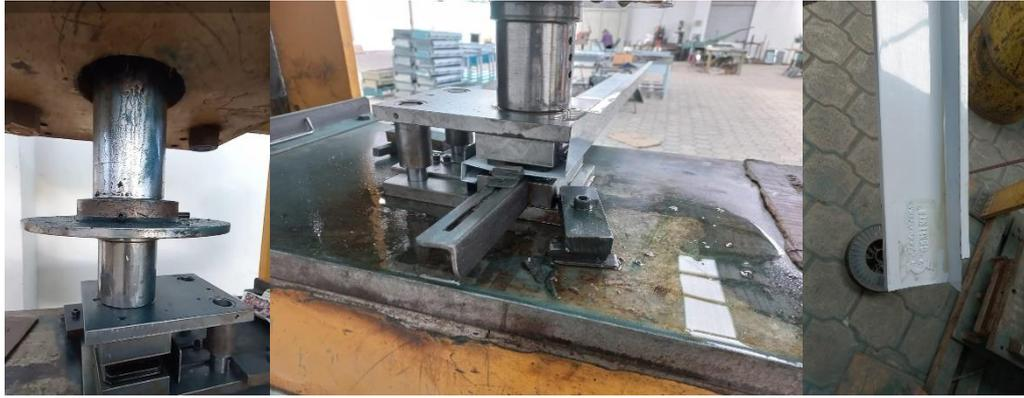
**Figura 38-3:** Identificación de la fuga de aceite del cilindro hidráulico
