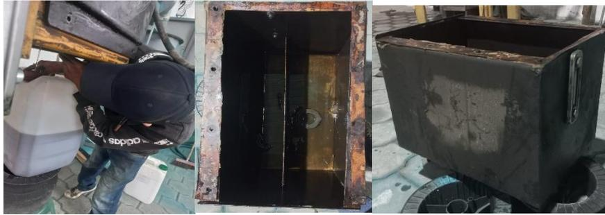
**Figura 41-3:** Daños en el tanque de aceite
