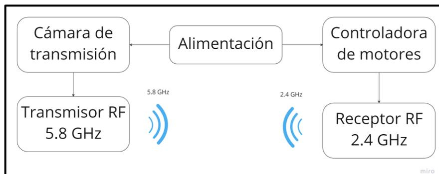
**Ilustración 4-3:** Diagrama de bloques de la etapa de comunicación.
