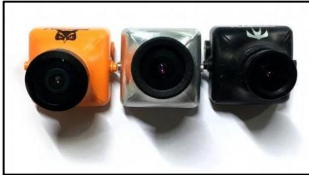
**Ilustración 17-2:** Cámaras utilizadas en los sistemas de tele operación o sistemas FPV.
