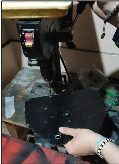
**Ilustración 32-3:** Modificación de la para superior trasera con el taladro.
