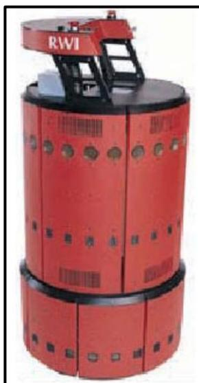
**Ilustración 7-2:** Robot Síncrono.
