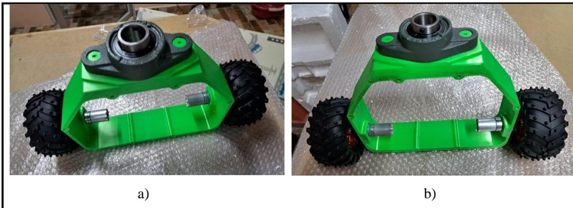
**Ilustración 34-3:** Montaje de primeros componentes en las estructuras diferenciales.
