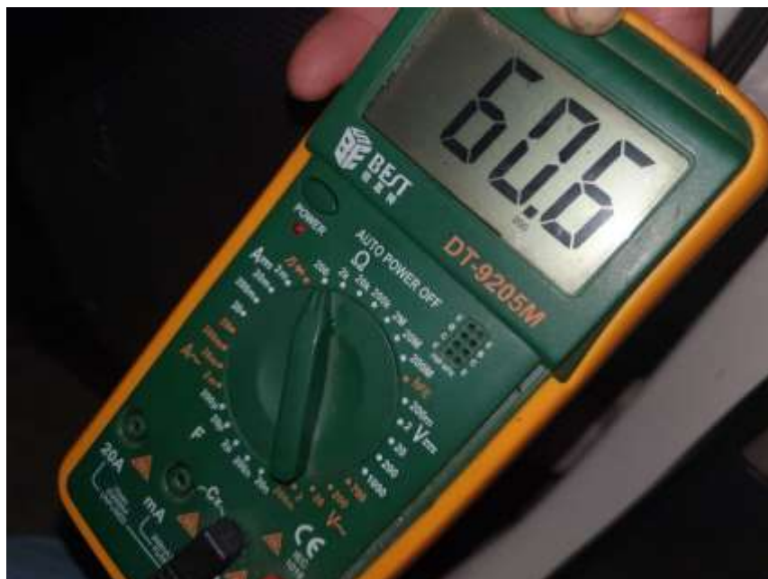
Ilustración 3-19: Resistencia entre las redes Can H y Can L
