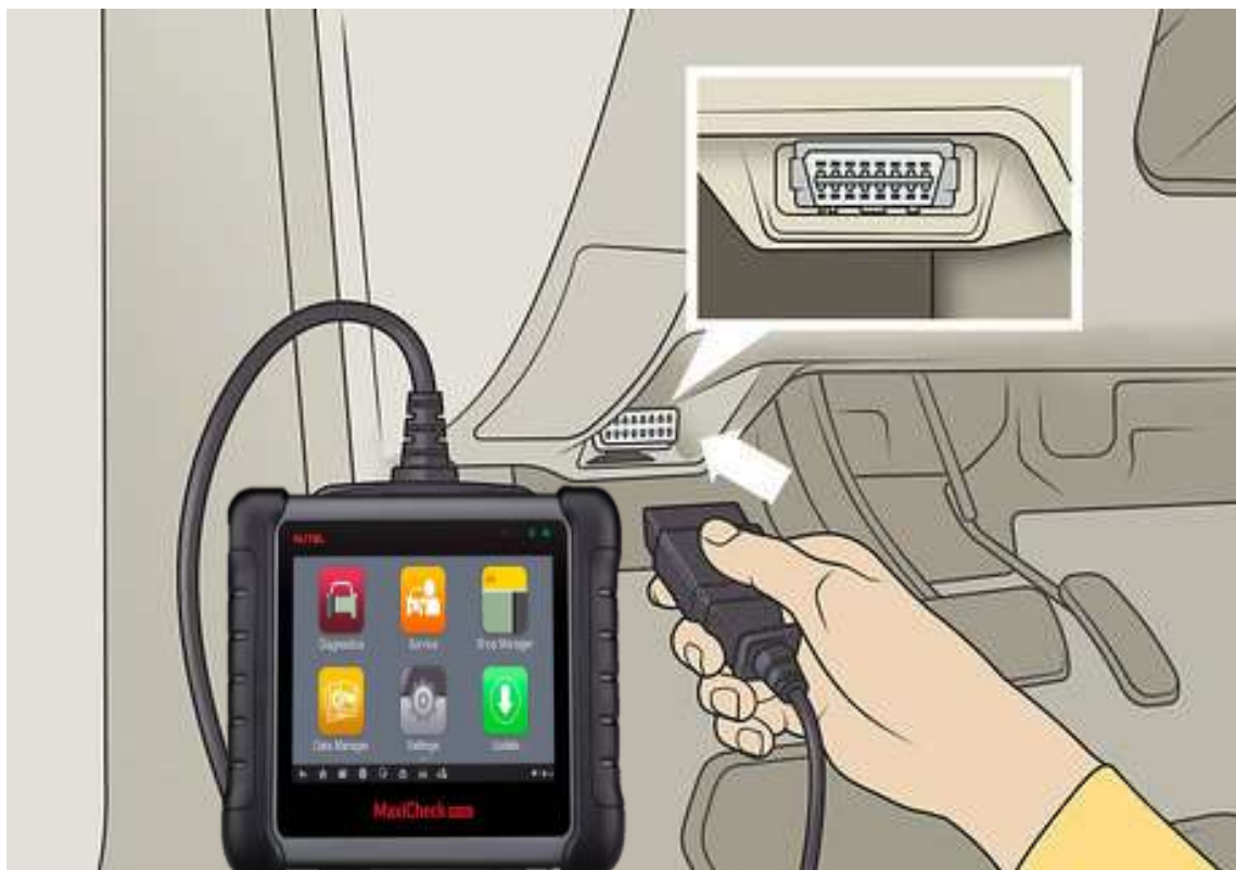
Ilustración 3-12: Conexión del escáner automotriz Autel Maxisys Ultra al vehículo
