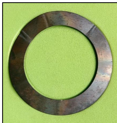
Ilustración 3-14: Junta metálica defectuosa
