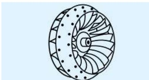
**Ilustración 2-8:** Rodete Helicocentrífugo.
