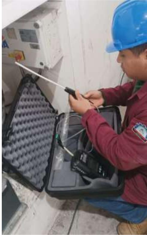
**Ilustración 3-3:** Registro de datos con el analizador MSA.
