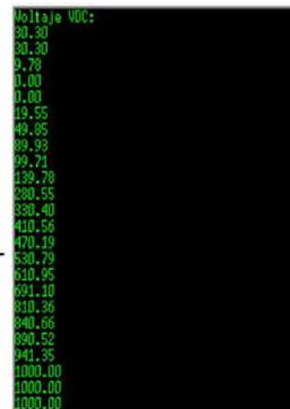
Ilustración 3-21: Resultados de simulación de sensor de voltaje JXDA4U.
