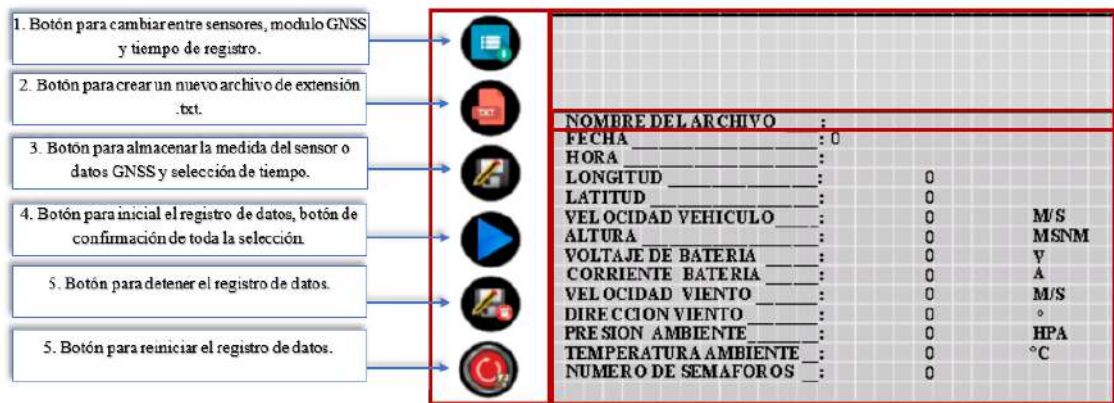
Ilustración 4-6: Botones para la interacción entre pantalla y usuario.
