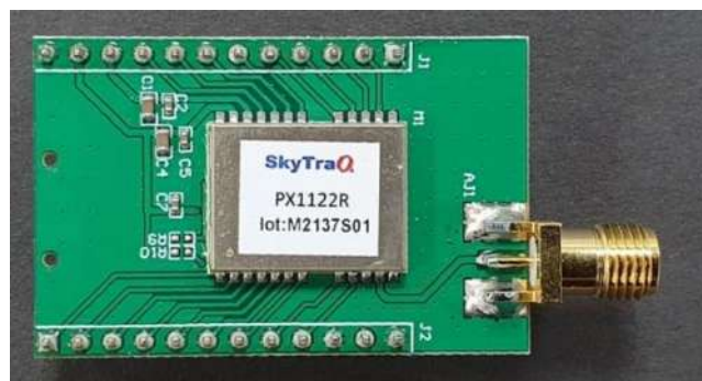
Ilustración 3-7: Módulo receptor GNSS NS-HP-GN2
