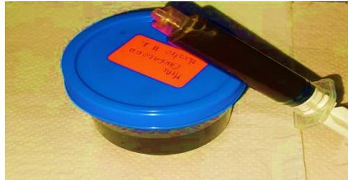
**Ilustración 3-5:** Toma de muestras de lubricante
