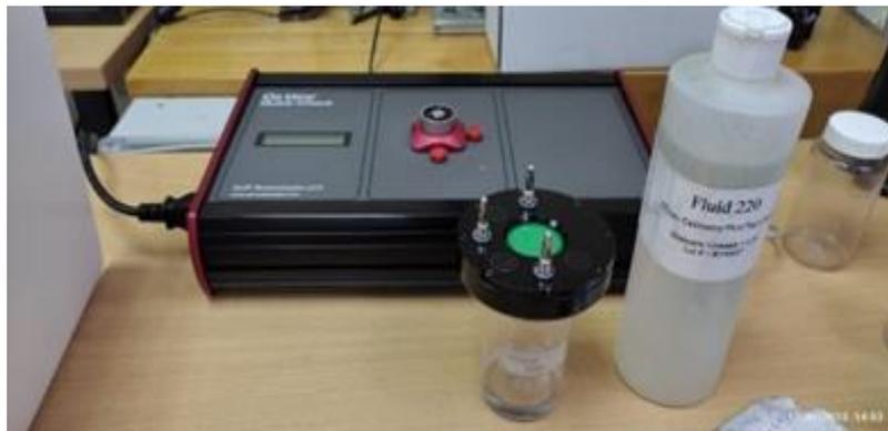
**Ilustración 3-15:** Análisis de las muestras en el Oil View Quick Check
