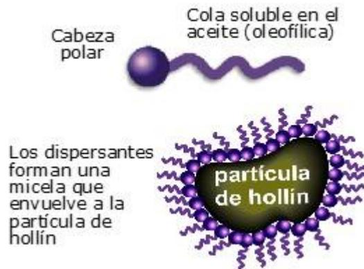
**Ilustración 2-14:** Dispersante de lubricante para a corrosión.
