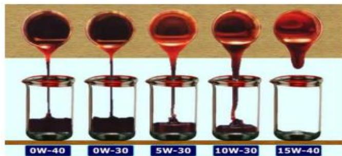
**Ilustración 2-18:** Viscosidad de un lubricante.
