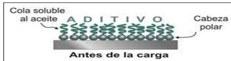
**Ilustración 2-16:** Aditivos anti desgaste esquema de actuación.
