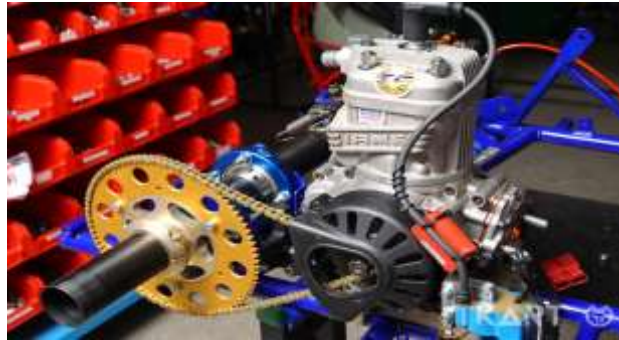
Ilustración 2-21: Sistema de transmisión del go kart
