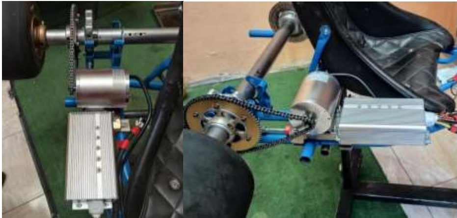
Ilustración 3-33: Tren eléctrico instalado en el go kart
