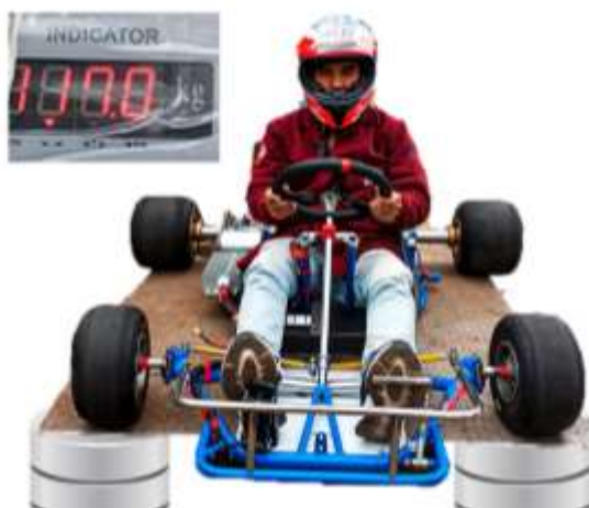
Ilustración 3-37: Pesaje del go kart eléctrico con su piloto
