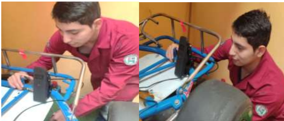
Ilustración 3-28: Instalación del pedal electrónico
