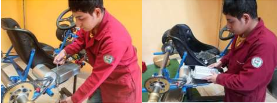
Ilustración 3-27: Instalación del controlador electrónico al go kart
