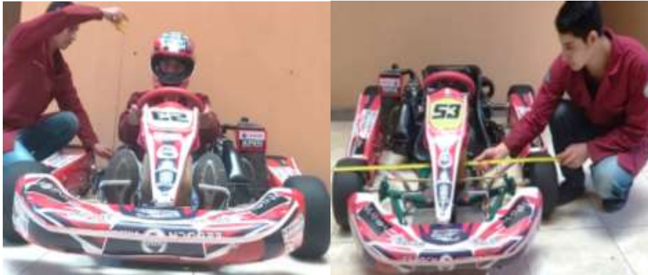
Ilustración 3-13: Obtención de las longitudes reales del go kart
