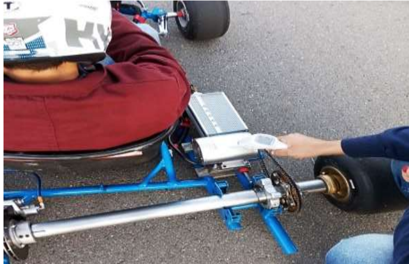
Ilustración 4-3: Obtención de la temperatura por el medidor de temperatura digital
