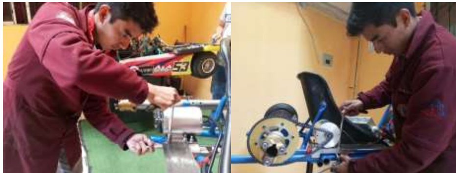
Ilustración 3-26: Instalación del motor eléctrico al go kart
