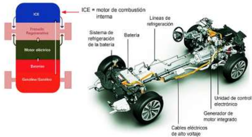
Ilustración 2-3: Estructura del vehículo eléctrico no enchufable (HEV)
