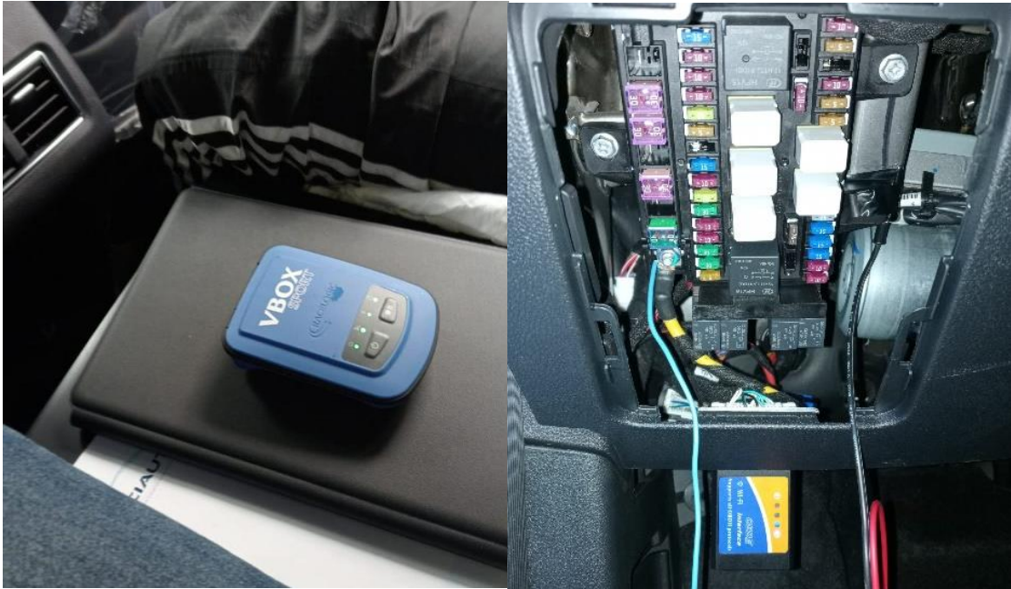
Ilustración 3-9: Conexión del equipo VBOX y OBD II
