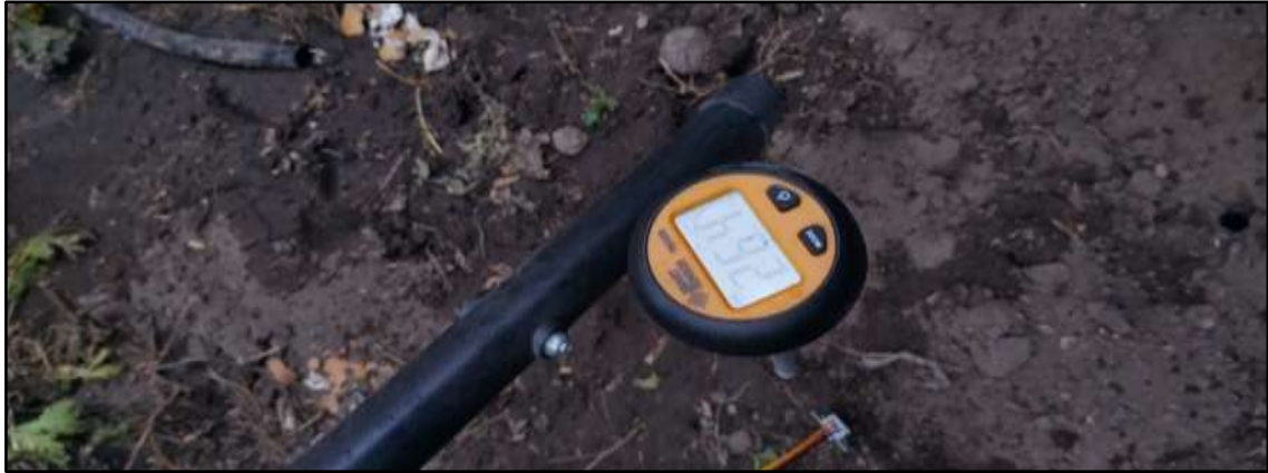
Ilustración 9-4: Sensor de humedad del suelo y medidor de calidad de suelo digital
