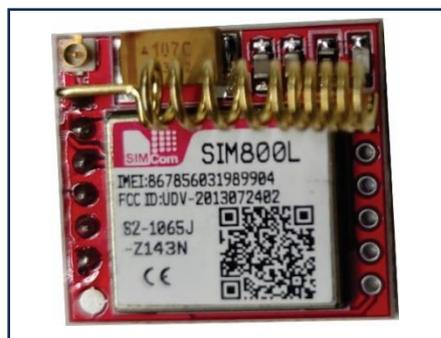
Ilustración 6-3: Módulo SIM800L.
