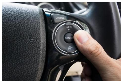
**Ilustración 3-2:** Control de velocidad tipo crucero.
