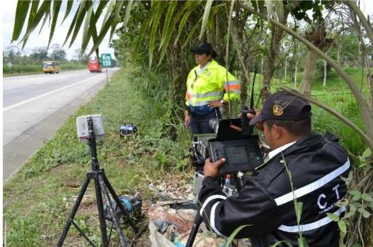
**Ilustración 7-2:** Fotorradar móvil.
