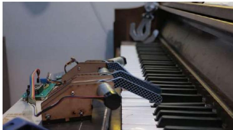
**Ilustración 2-2.** Diseño de controles y hardware de dedos robóticos para tocar el piano
