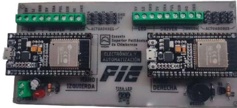
**Ilustración 3-37.** Placa PCB implementada físicamente
