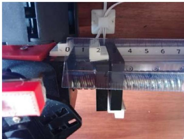
**Ilustración 4-4.** Evidencia de toma de datos para la estabilidad del sensor magnético de la mano derecha
