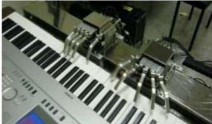
**Ilustración 2-5.** Diseño de una mano robótica para tocar el piano
