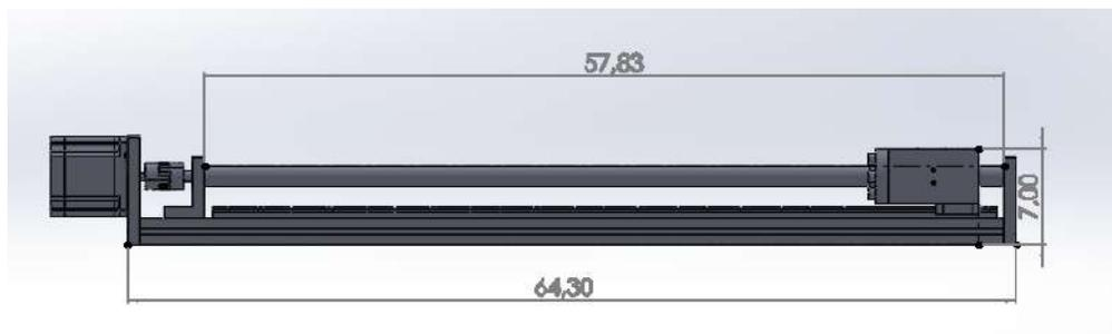
**Ilustración 3-25.** Modelo 3D del tornillo lineal
