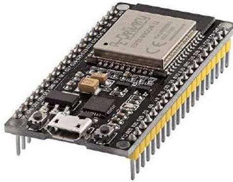
**Ilustración 3-32.** Microcontrolador ESP32
