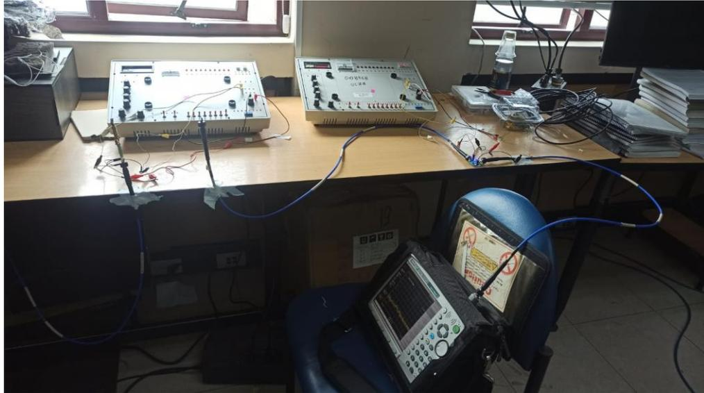
**Ilustración 4-7:** Utilización del generador de señales, analizador de Espectros y fuente de poder variable para las mediciones de la antena Bow-tie a 28GHz
