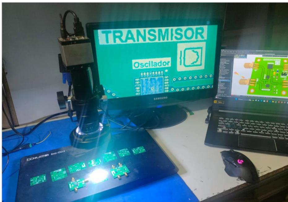
**Ilustración 3-24:** Proceso de soldado, utilizando una lupa de aumento de las placas PCB
