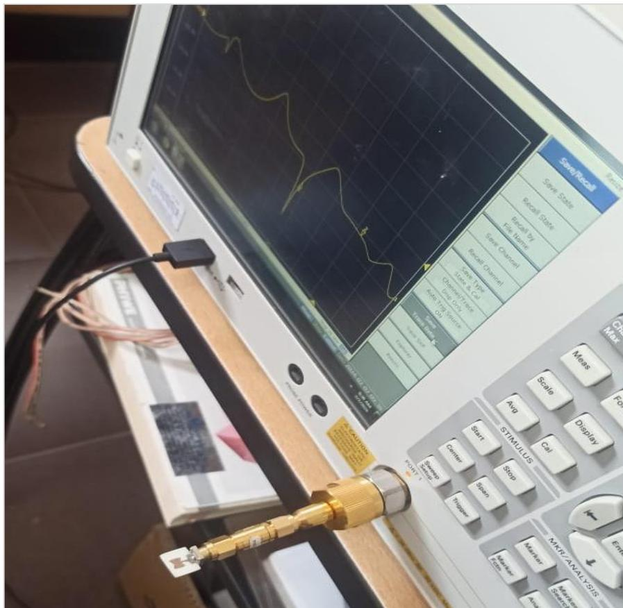
**Ilustración 4-2:** Verificación del funcionamiento de la Antena bow-tie en el VNA
