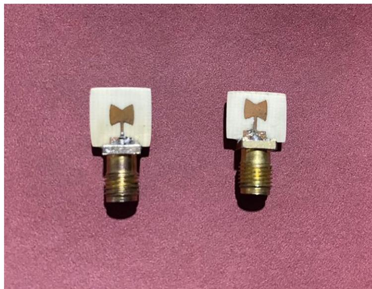
**Ilustración 3-30:** Implementación final de las Antenas Bow-tie
