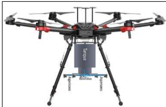
Ilustración 6-3: Tentativa de colocación del tanque
