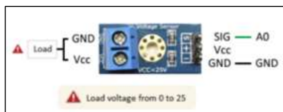
Ilustración 8-3: Estructura del sensor FZ0430
