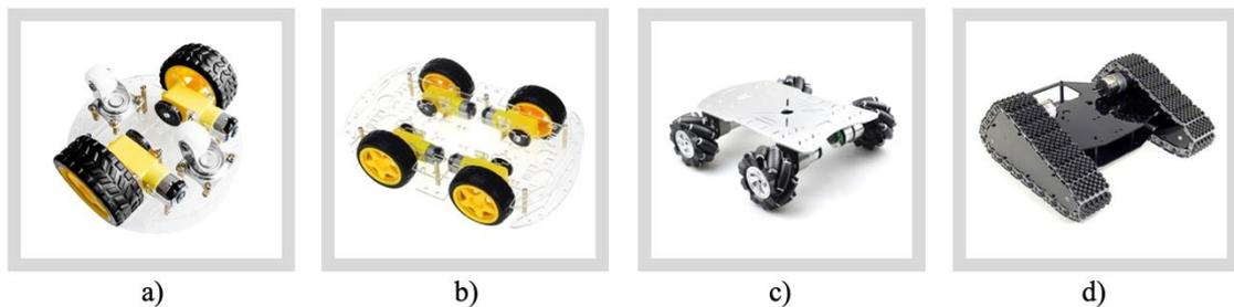
**Ilustración 2-7:** Locomoción: a) diferencial, b) convencional, c) omnidireccional, d) oruga
