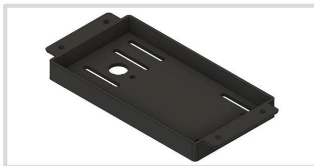
**Ilustración 3-33:** Diseño de la base del robot móvil
