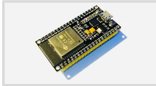
**Ilustración 3-10:** Tarjeta NodeMCU-32
