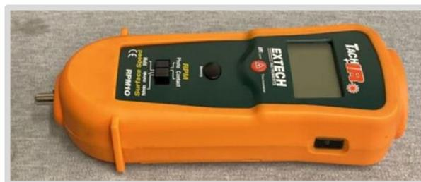
**Ilustración 4-4:** Tacómetro Extech RPM 10
