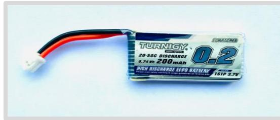
**Ilustración 3-9:** Batería LiPo Turnigy 1s
