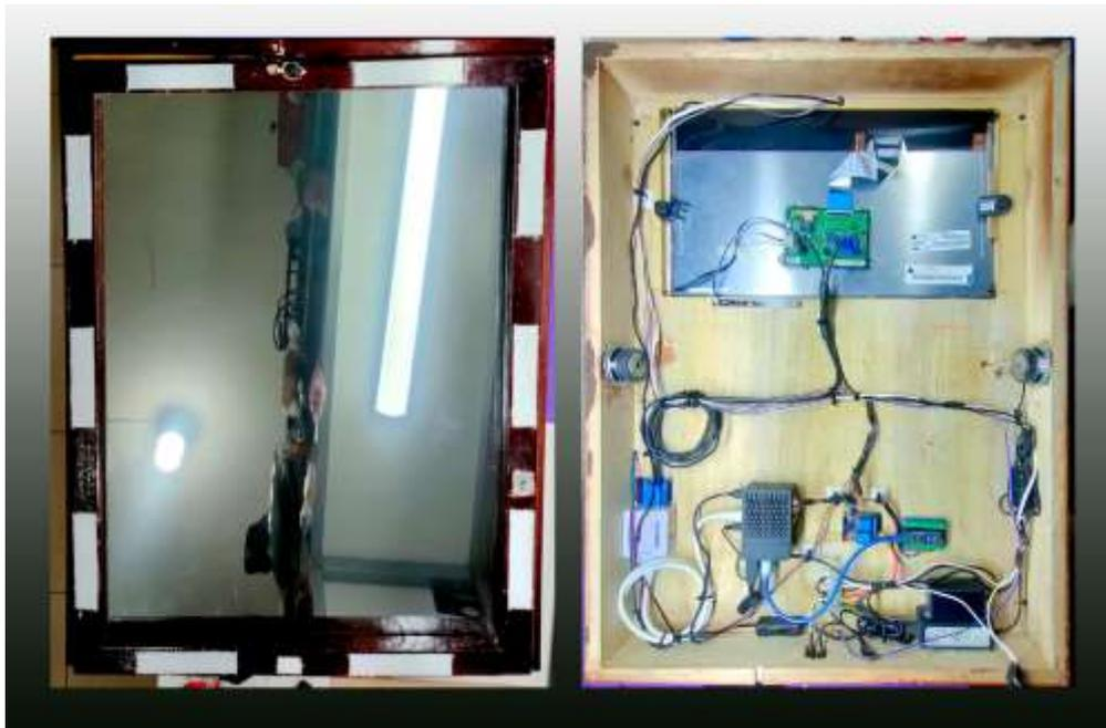
**Ilustración 1-4.** Dispositivo electrónico medidor de constantes vitales
