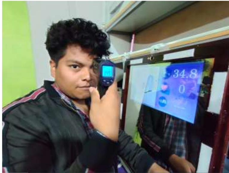
**Ilustración 2-4.** Toma de muestras entre el equipo patrón y el dispositivo
