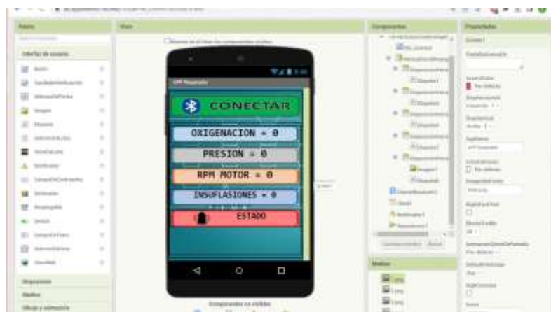
Ilustración 3- 35: Ambiente de programación APP Inventor para el diseño de la aplicación móvil.
