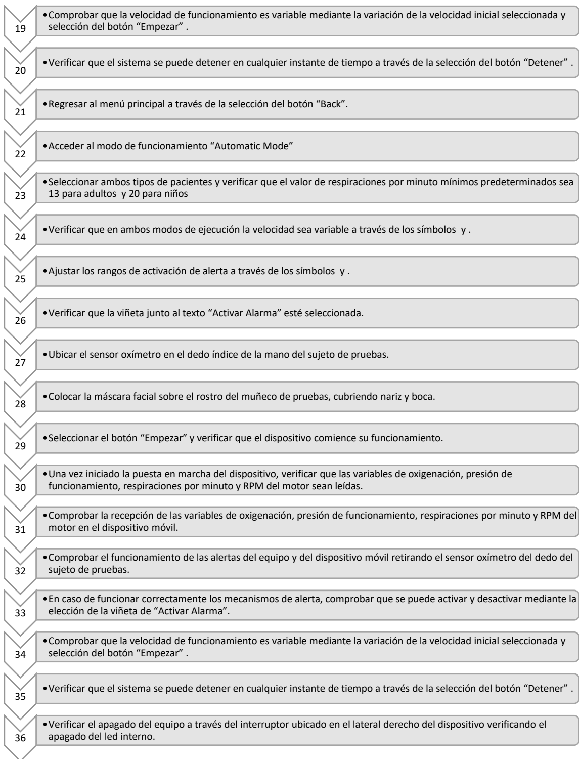
Ilustración 4- 1: Diagrama de procesos de protocolo de pruebas del respirador mecánico de presión positiva tipo AMBU.
