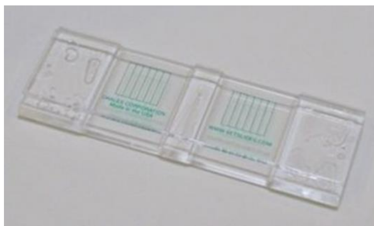
Ilustración 2-27 Cámara de recuento McMaster
