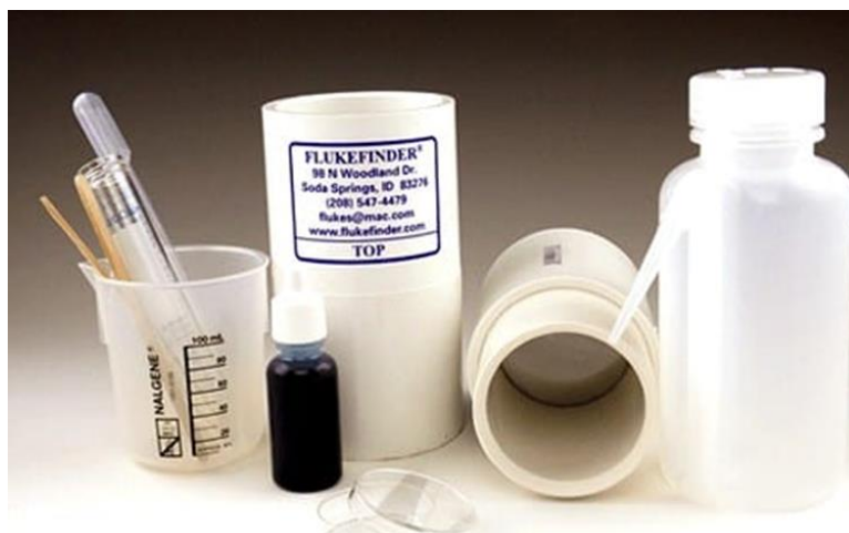
Ilustración 2-26 :Instrumentos para realizar la técnica Flukefinder
