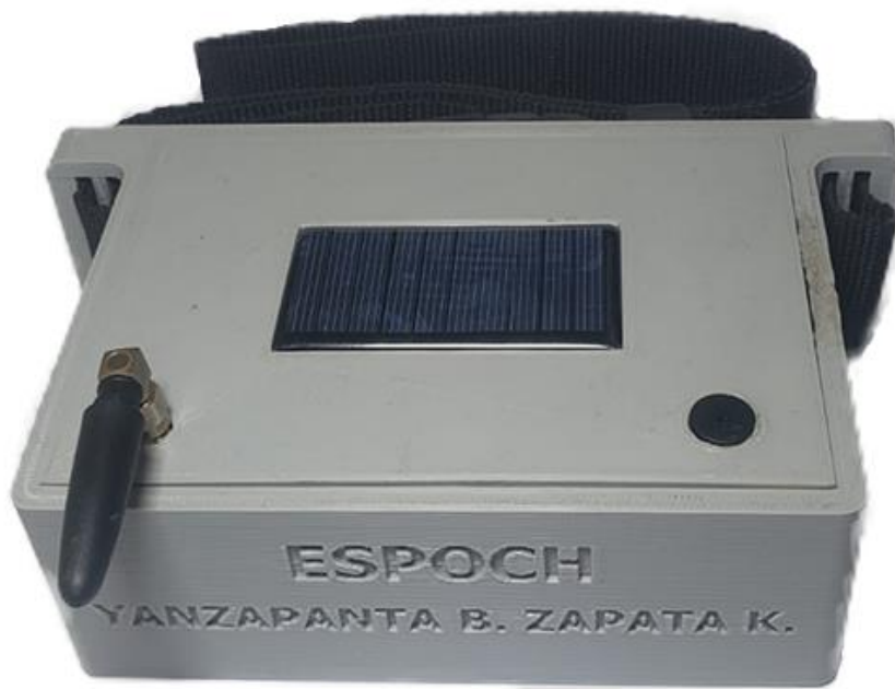
Ilustración 3-26: Carcasa impresa en 3D.
