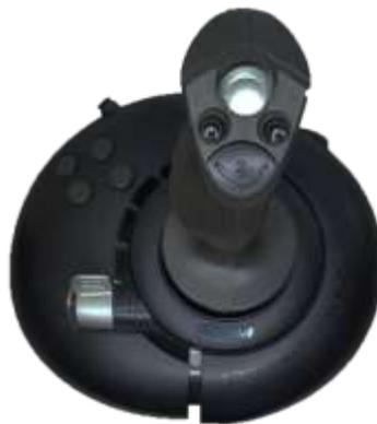
**Ilustración 8-3: Dispositivo Háptico Sidewinder Force Feedback 2.**
