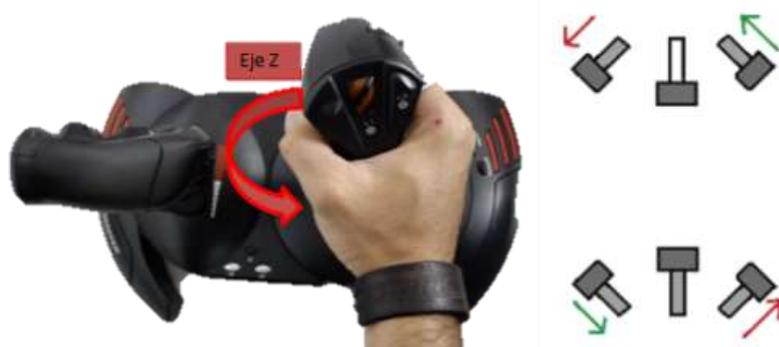
**Ilustración 17-2: Control de orientación con el uso de Joystick en el ROV USFQ.**
