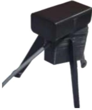
**Ilustración 36-3: Impresión de la estructura integrada a la boya en material PLA.**
