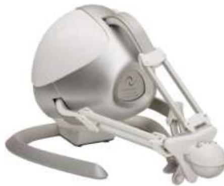
**Ilustración 19-2: Dispositivo Háptico Novint Falcon.**
