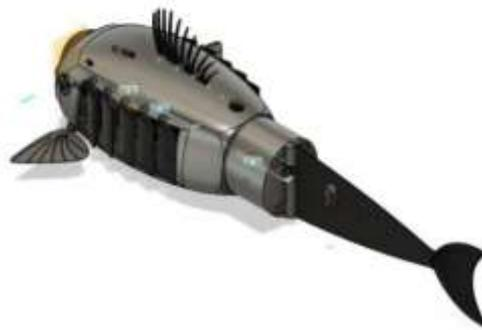
**Ilustración 8-2: Robot Bioinspirado Robo-Fish.**
