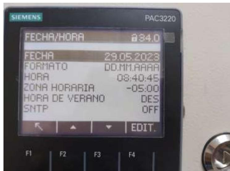
**Figura 9-3.** Parámetros de fecha y hora del medidor de energía.
