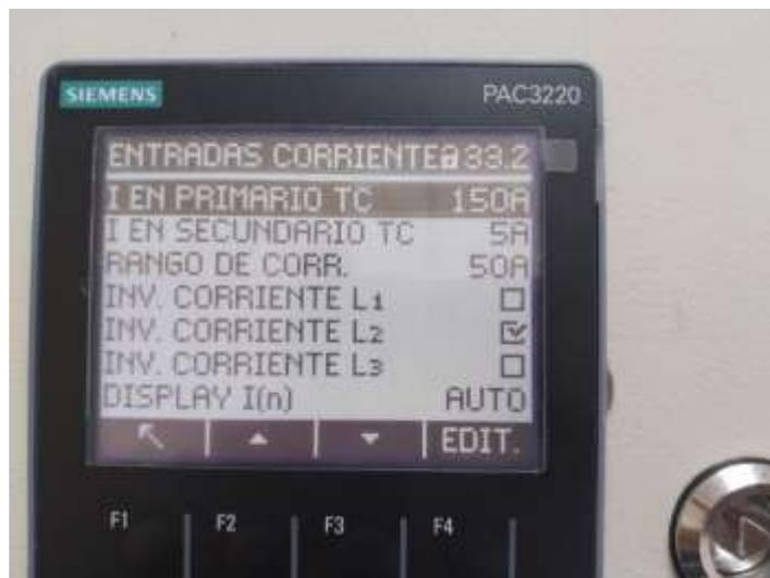
**Figura 14-3.** Configuración de la entrada de corriente.
