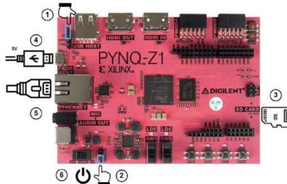
**Ilustración 3-7.** Configuración de la FPGA
