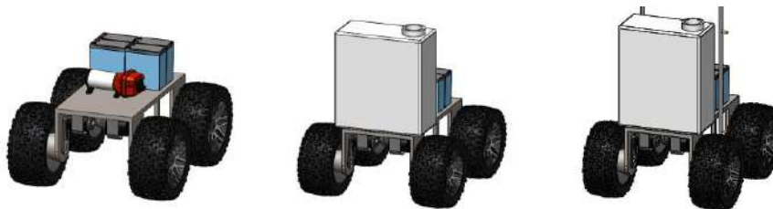
Ilustración 11-3: Acople de elementos en la base del prototipo
