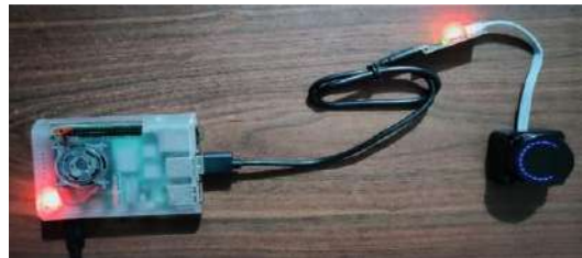
Ilustración 31-3: Activación del sensor LiDAR LD06 mediante comunicación serial con la Raspberry
