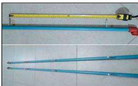
Ilustración 28-3: Ubicación de las boquillas de pulverización a 50cm
