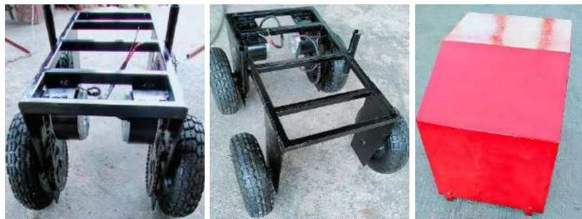
Ilustración 26-3: Estructura metálica del prototipo
