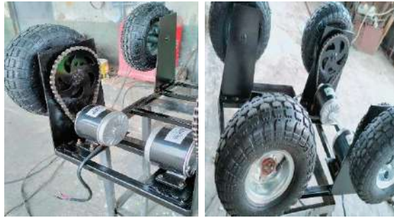
Ilustración 25-3: Sistema de transmisión para los motores del prototipo
