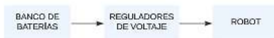
Ilustración 6-3: Diagrama de bloques para la alimentación del prototipo Realizado por: Aguagallo Christian, 2023
