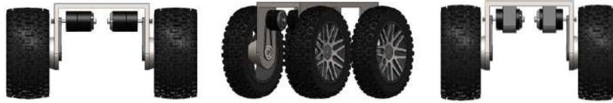
Ilustración 10-3: Motores acoplados a la base con sus soportes y poleas conectadas para el sistema de transmisión
