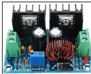
Ilustración 19-3: Regulador de voltaje XL4016
