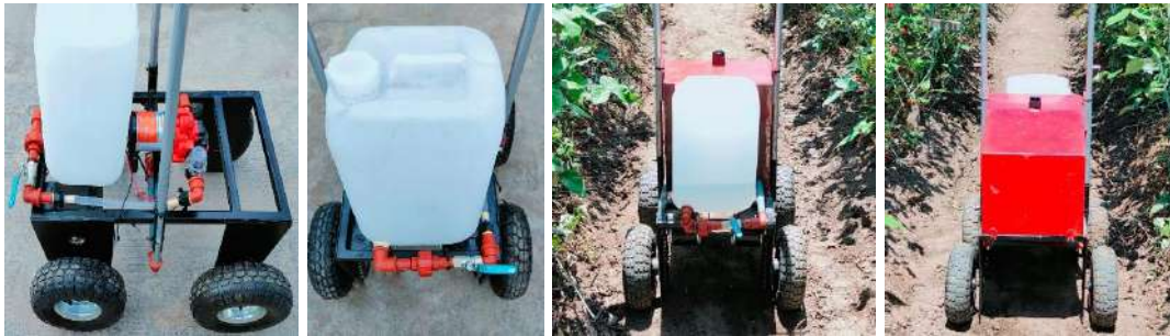
Ilustración 29-3: Sistema de pulverización: conexión a la bomba y al contenedor
