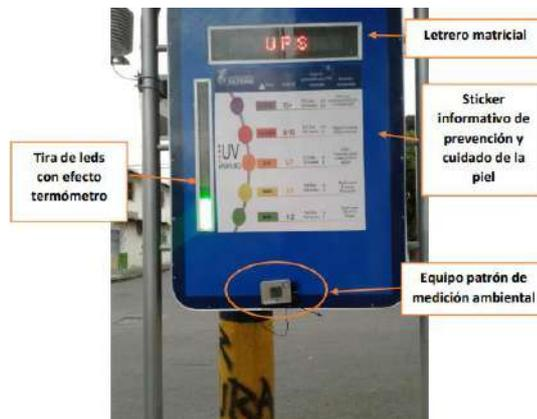
**Ilustración 4-2:** Medidor de radiación UV
