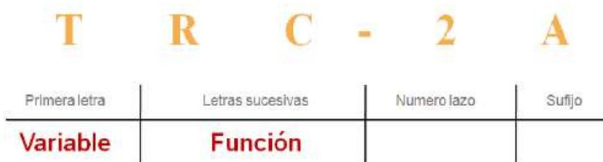
**Ilustración 21-2:** Identificación de instrumentos en el diagrama P&ID.
