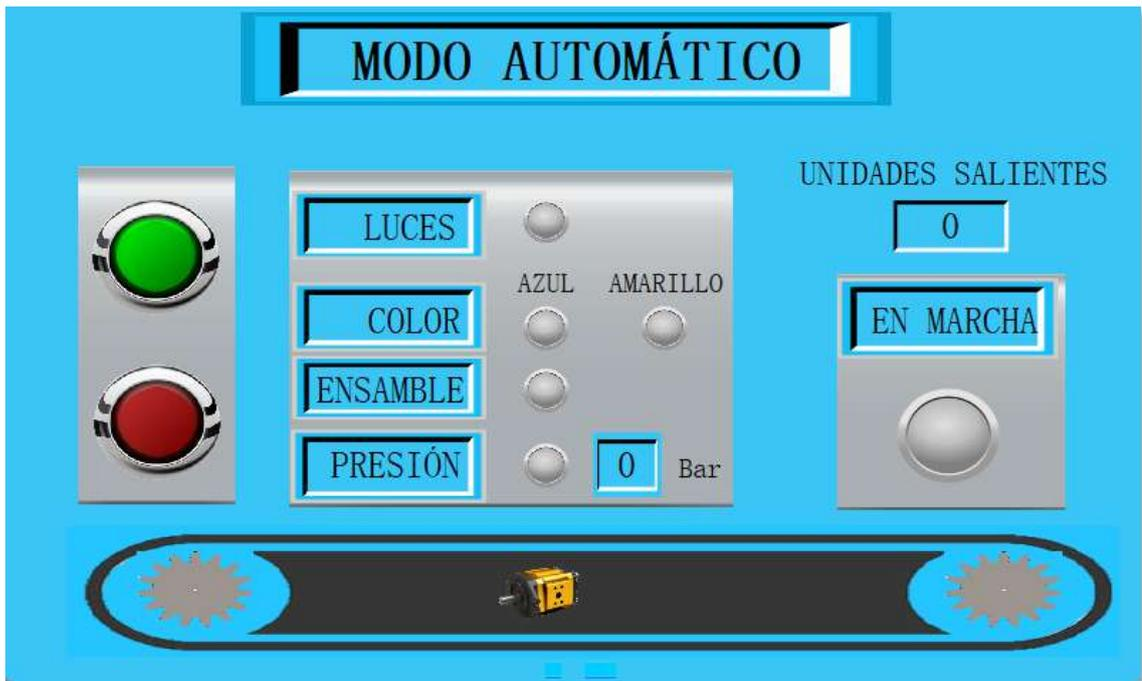
**Ilustración 43-3:** Diseño de la pantalla en modo automático.
