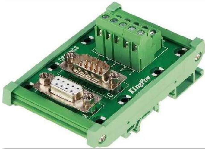
**Ilustración 13-3:** Interfaz de comunicación DB9-MG6
