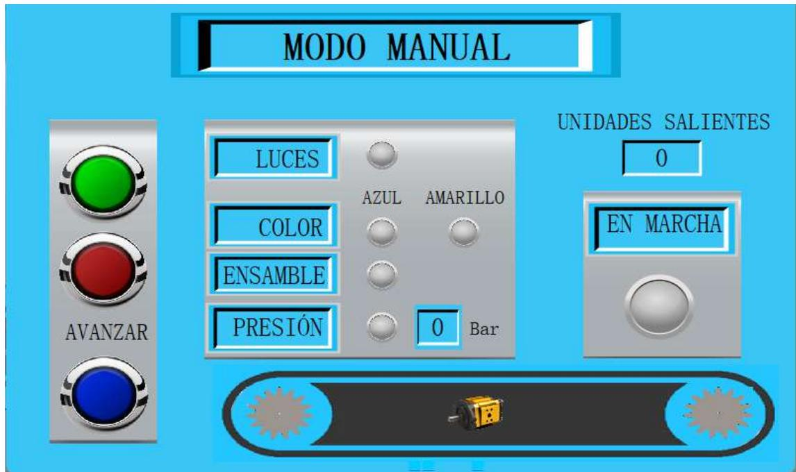
**Ilustración 42-3:** Diseño de la pantalla en modo manual.
