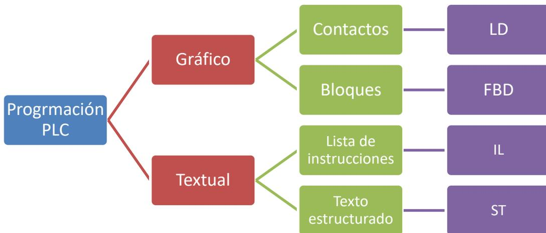
**Ilustración 15-2:** Lenguajes de programación según la norma IEC 113-3.
