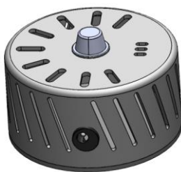
Ilustración 40-3: Diseño de la estructura de los nodos de detección de fugas de gas y humo
