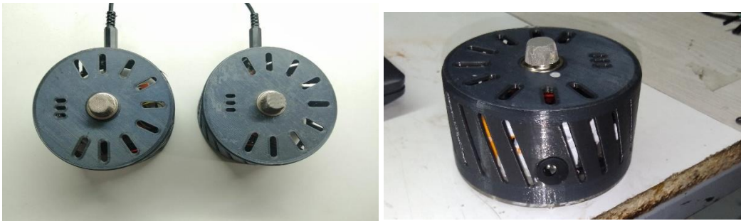
Anexo R: Diseño físico de la estructura del nodo central de información
