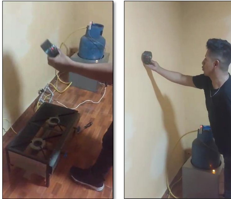
Ilustración 7-4: Toma de muestras con gas GLP y el dispositivo de detección de gas GLP
