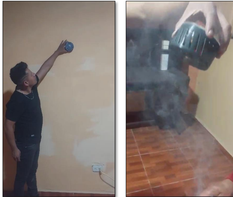
Ilustración 8-4: Toma de muestras con inciensos, cartulina de papel y el dispositivo de detección de humo
