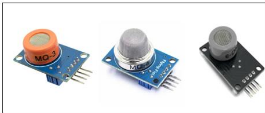
Ilustración 4-2: Tipos de sensores MQ
