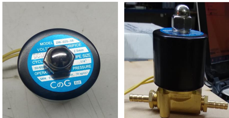
Ilustración 10-3: Electroválvula Solenoidal 2W-025-08
