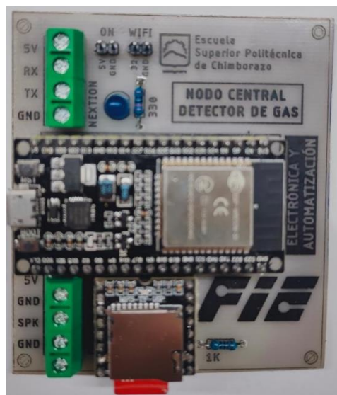
Ilustración 25-3: Placa PCB del nodo central
