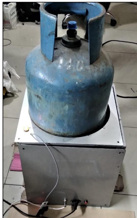
Ilustración 3-4: Colocación el cilindro de gas en el prototipo
