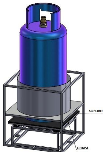
Ilustración 38-3: Unión de la parte inferior y Soporte del prototipo.
