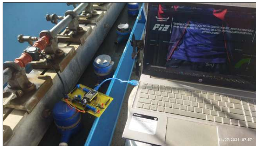
Figura 5-2: Medidor propuesto en el banco de pruebas de la EP-EMAPAR.
