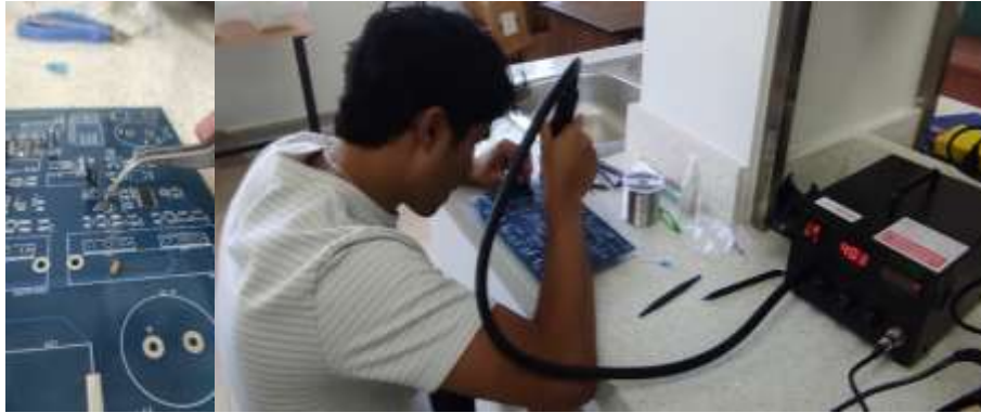
Ilustración 42-4 : Proceso de soldadura de los elementos que conforman la PCB del Convertidor TAB DC-DC.
