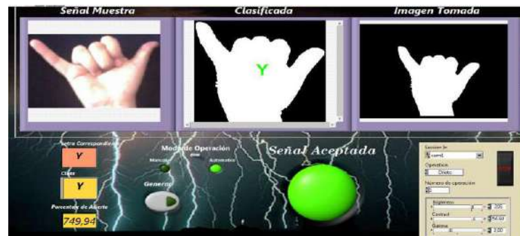
Ilustración 8-2: Sistema traductor de lenguaje de señas con Visión Artificial.
