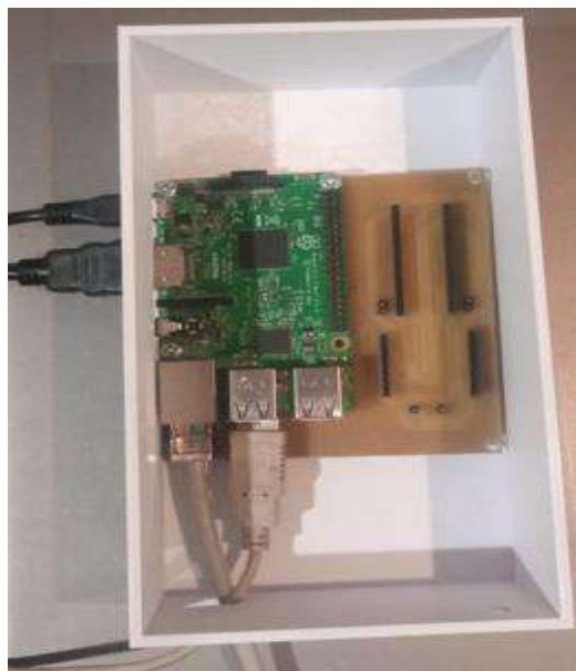
Figura 3-4. PCB implementada para el nodo Gateway en el interior de la vivienda.
