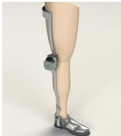
Figura 2-1: Órtesis para piernas con actuadores en sus articulaciones
