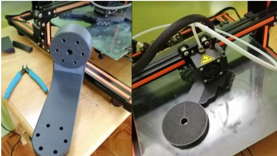
Figura 42-2: Impresión del prototipo en fibra de carbono. Realizado por: JIMENEZ, Byron, 2019
