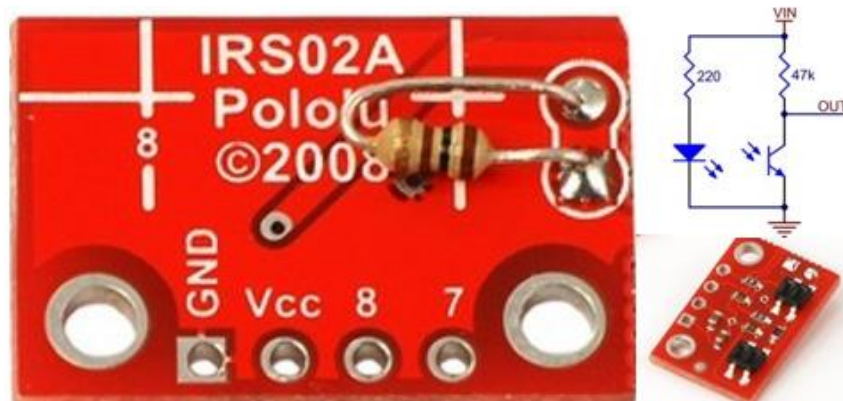
Figura 8-2: Sensor qtr2A Fuente: (Pololu, 2019)
