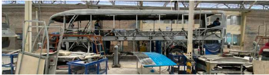
Ilustración 3-8: Área de forrado en la planta de MEGABUUSS CIA. LTDA.
