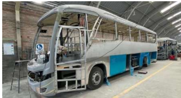
Ilustración 3-14: Área de pre acabados en la planta de MEGABUUSS CIA. LTDA.
