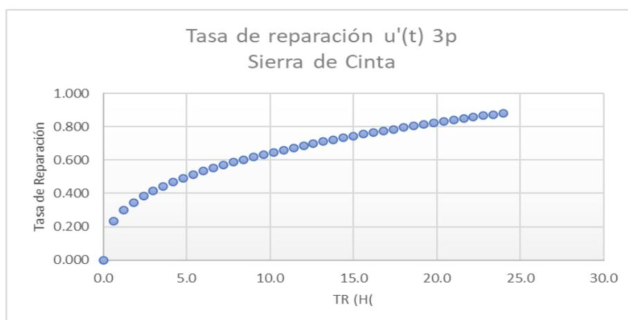
**Ilustración 4-33:** Tasa de reparación de Weibull – tri paramétrico
