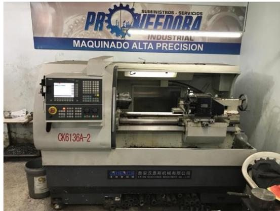
**Ilustración 2-5: Torno CNC**
