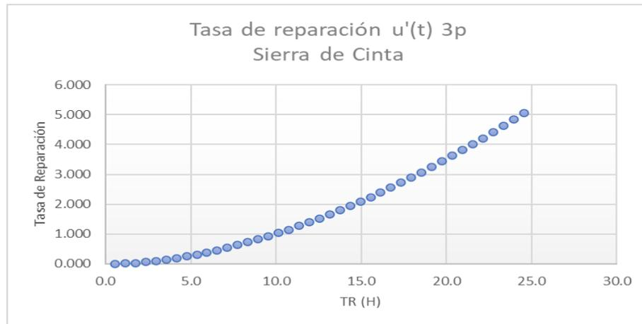
**Ilustración 3-39:** Tasa de reparación de Weibull – tri paramétrico
