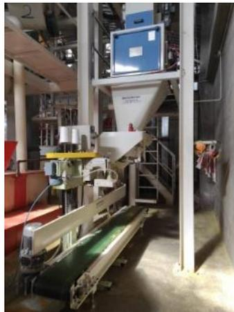
**Ilustración 3-10:** Ensacadora.
