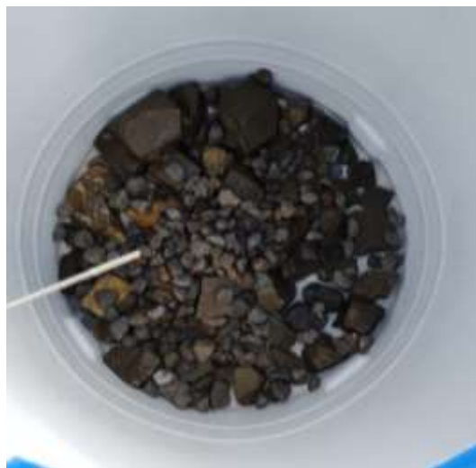
Ilustración 3-19: Colocación de la capa de grava soporte
