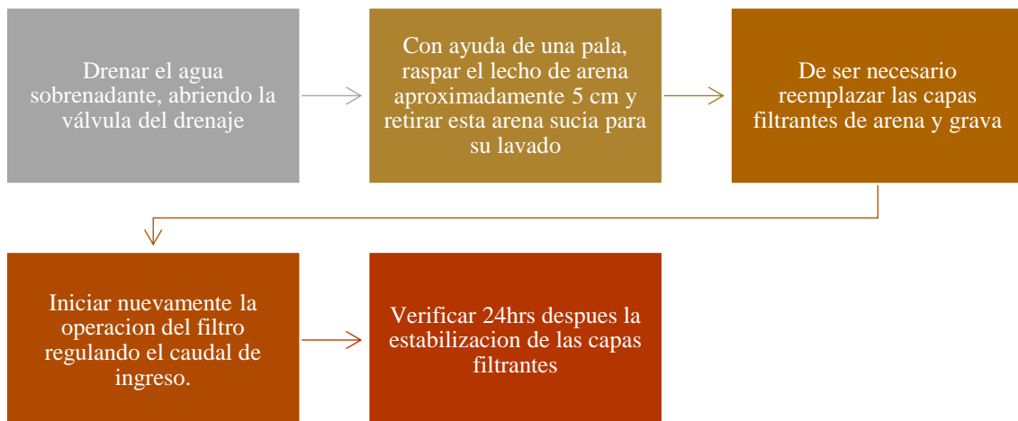
Ilustración 3-26: Procedimiento de limpieza del filtro lento de arena.
