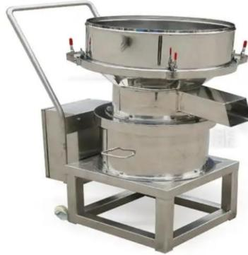
**Ilustración 4-4:** Tamizador vibratorio
