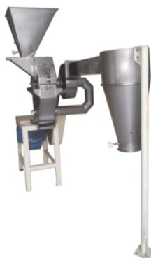
**Ilustración 4-3:** Molino de martillo MV 15-45 I/C
