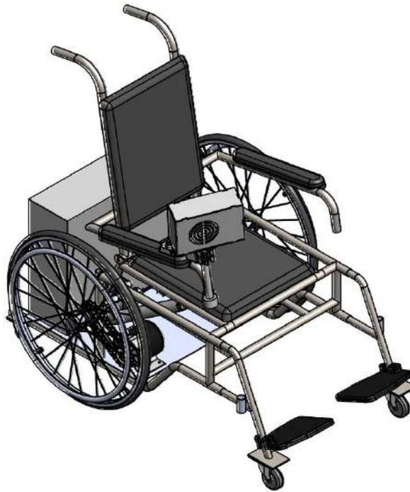
**Ilustración 3-9:** Diseño CAD final del prototipo
