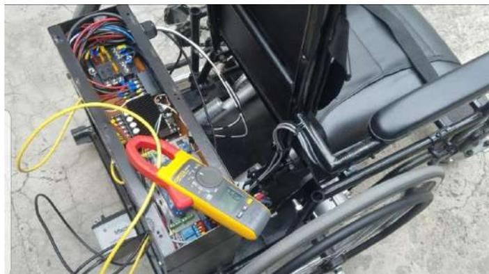
**Ilustración 4-15:** Medición consumo motores sin peso.
