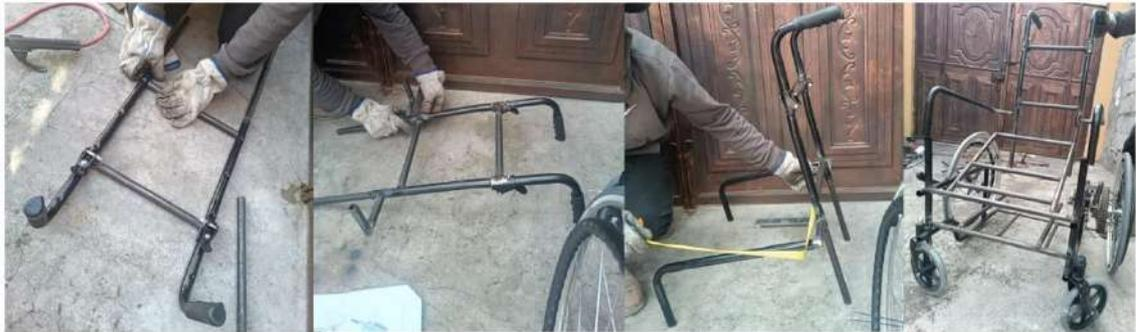
**Ilustración 3-27:** Construcción del espaldar del prototipo
