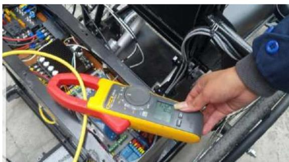
**Ilustración 4-12:** Medición consumo fase encendido.
