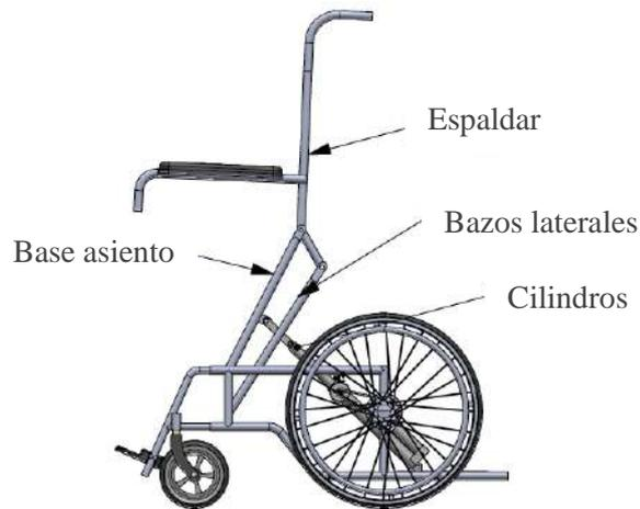
**Ilustración 3-5:** Elementos de análisis sistema de bipedestación
