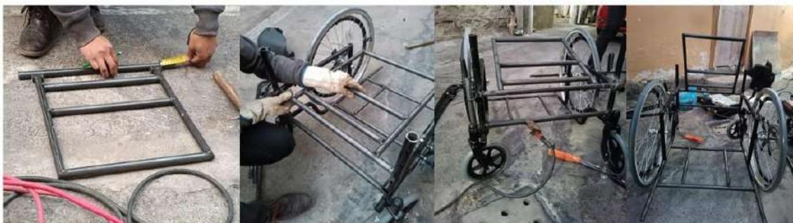
**Ilustración 3-26:** Construcción del asiento móvil del prototipo
