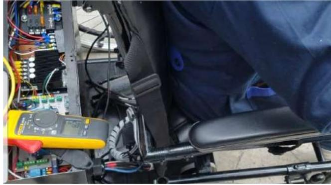
**Ilustración 4-16:** Medición consumo motores peso 70 kg.
