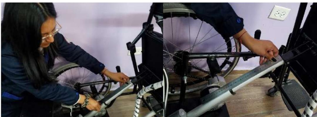
**Ilustración 4-6:** Medición de recorrido del actuador lineal.
