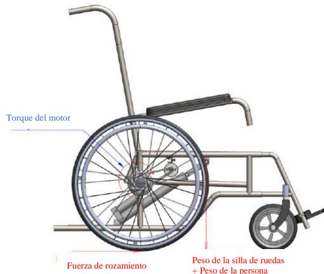
**Ilustración 3-11:** Análisis sistema motorizado de ruedas
