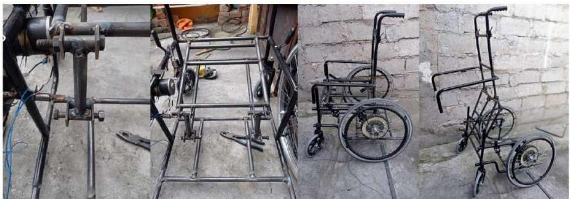
**Ilustración 3-28:** Construcción del sistema de bipedestación
