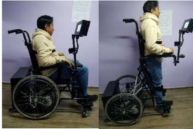
**Ilustración 4-3:** Registro de tiempos de subida y bajada con peso 60 kg.
