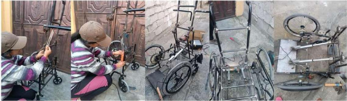
**Ilustración 3-29:** Fijación de los ángulos y ubicación de los actuadores
