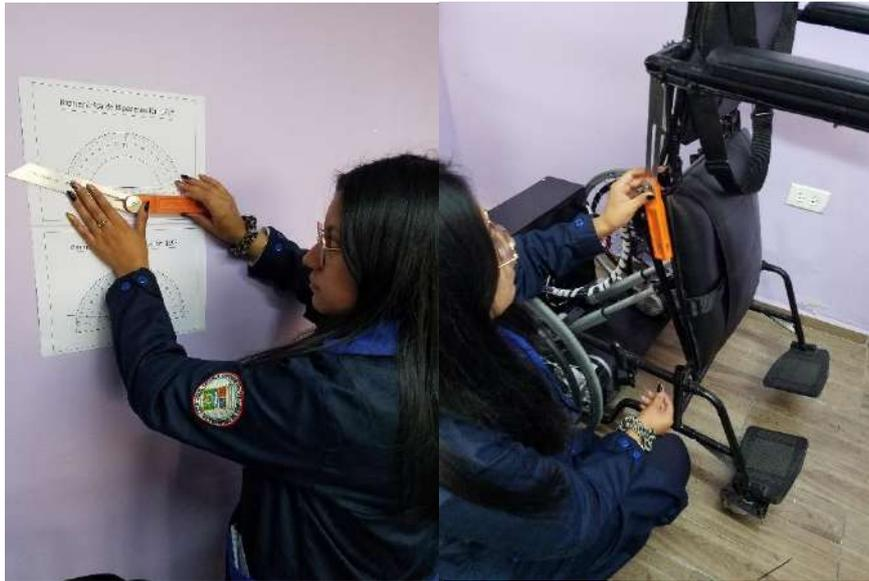
**Ilustración 4-7:** Verificación de ángulo de bipedestación de  $163^{\circ}$  en el prototipo.
