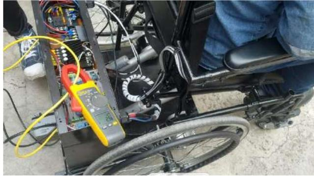
**Ilustración 4-14:** Medición consumo bipedestación peso 70 kg.
