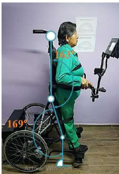
**Ilustración 4-9:** Verificación de ángulos de bipedestación con peso de 70 kg.
