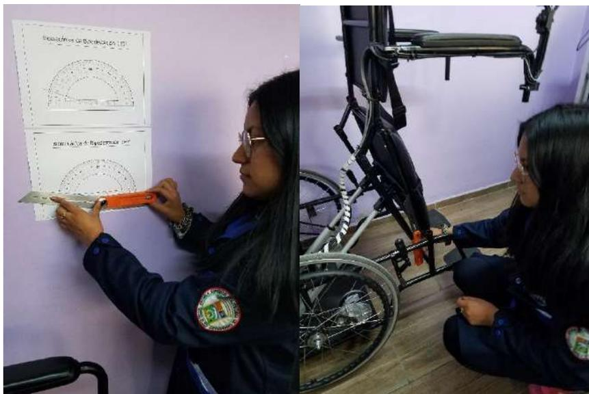
**Ilustración 4-8:** Verificación de ángulo de bipedestación de  $169^{\circ}$  en el prototipo.
