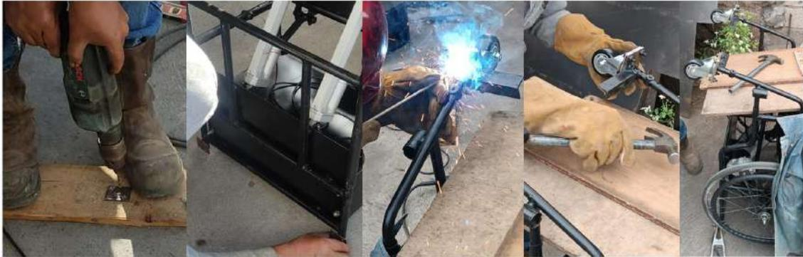
**Ilustración 3-32:** Adaptación de ruedas móviles delanteras y posteriores
