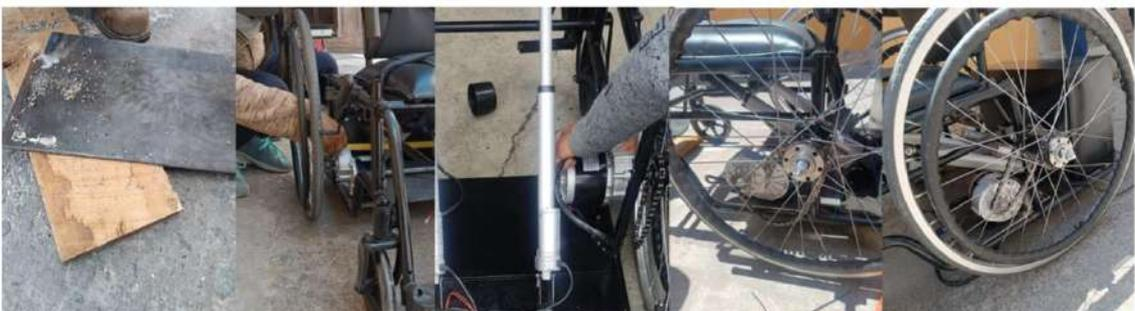
**Ilustración 3-30:** Adaptación de las ruedas al prototipo
