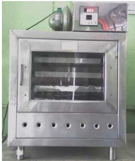
**FOTOGRAFÍA No. 5. SECADOR DE BANDEJAS**
