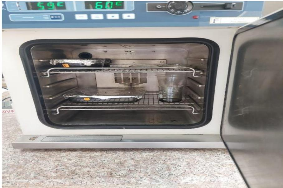
**Ilustración 3-19:** Secado de las NP-Fe<sub>2</sub>O<sub>3</sub>
