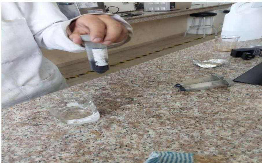
**Ilustración 3-17:** Lavado con alcohol al 70% de las NP-Fe<sub>2</sub>O<sub>3</sub>
