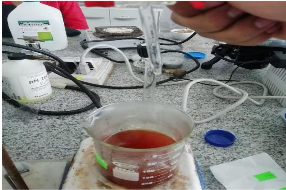
**Ilustración 3-13:** Goteo constante de NaOH
