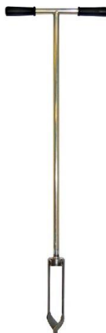
Figura 2- 20: Barreno Holandés con punto helicoidal.
