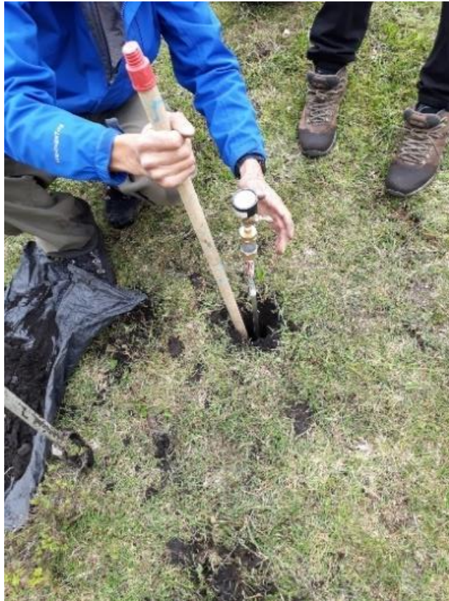
Anexo 3: Colocación de la sonda de acero inoxidable.
