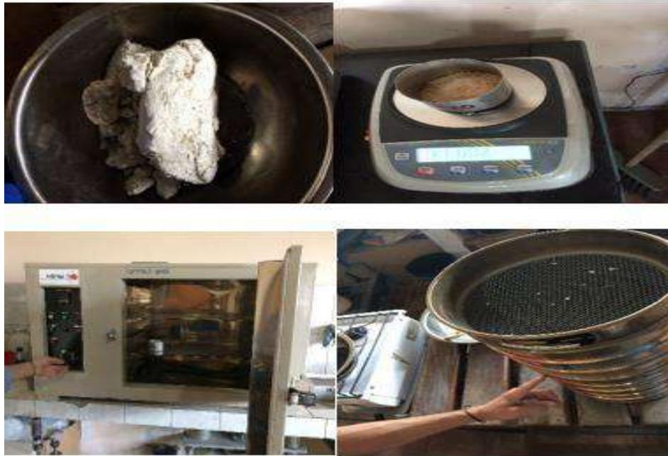
**Ilustración 3-6.** Instrumentos para el ensayo Granulométrico.
