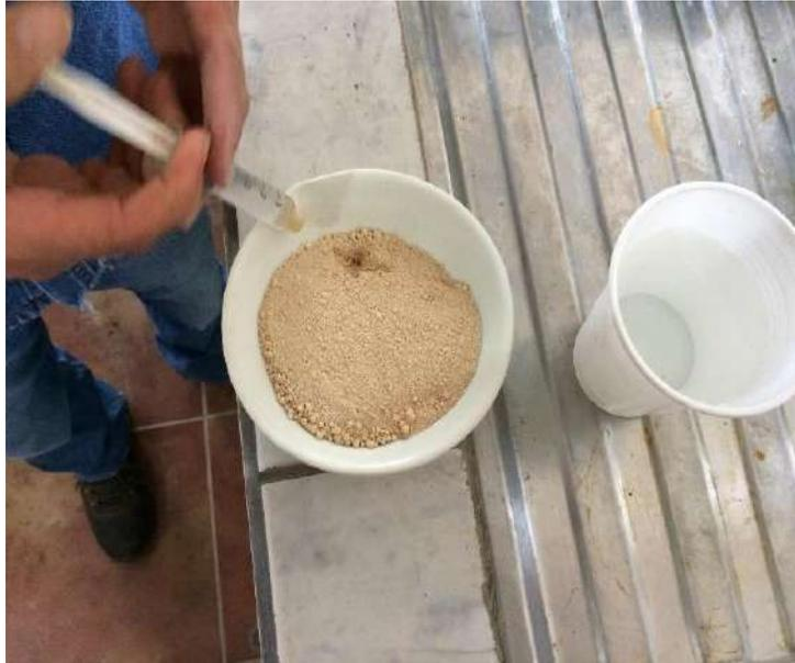
**Ilustración 3-17.** Agregado de agua de 15 a 20 ml.
