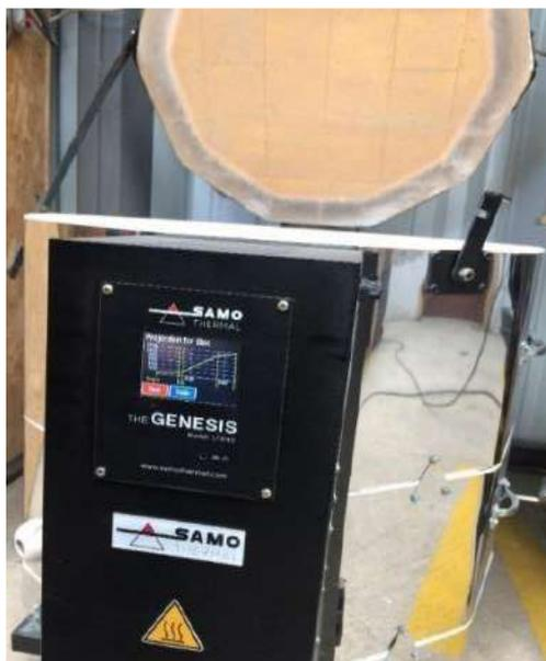
**Ilustración 3-27.** Horno electrónico para cocción de cerámica.
