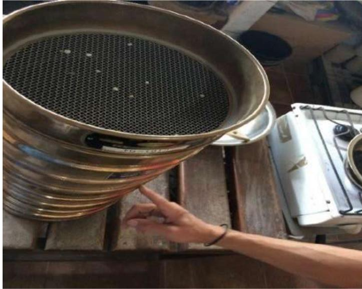
**Ilustración 3-10.** Armado de la serie de tamices.
