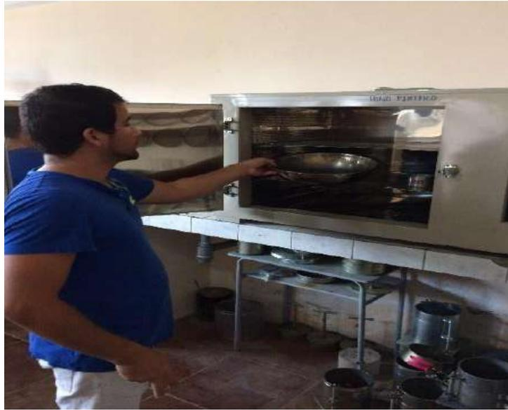
**Ilustración 3-14.** Secado de la muestra a 110°C.
