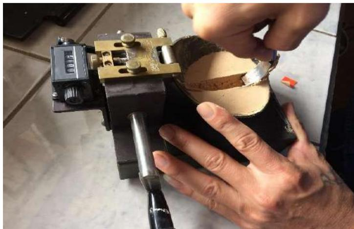
**Ilustración 3-18.** Ranura en el eje de simetría de la cápsula de Casagrande.
