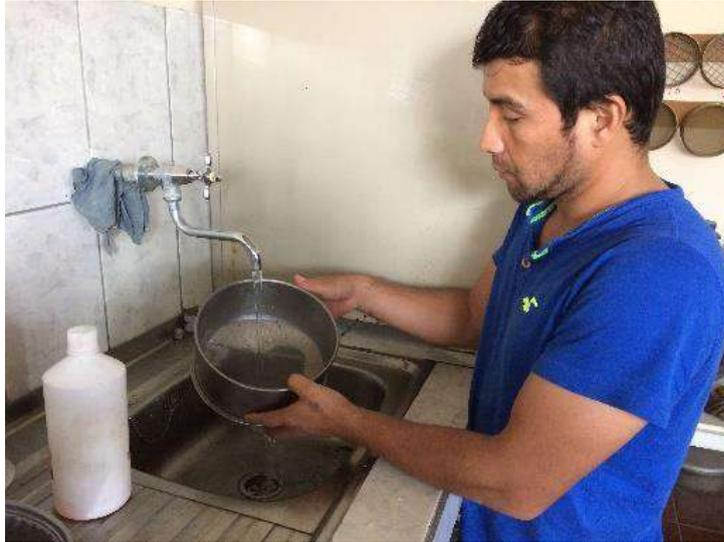
**Ilustración 3-12.** Retirado de la muestra retenida en el tamiz.
