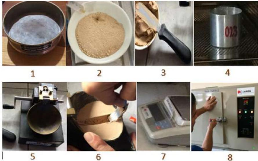
**Ilustración 3-16.** Instrumentos y materiales para determinar plasticidad, LL y LP.
