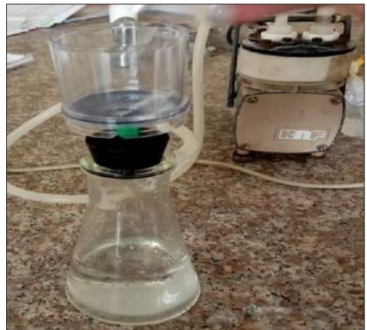
Filtración de membrana
