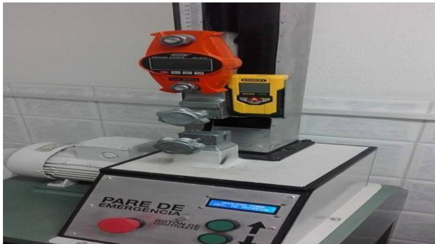
Figura 2-1: Partes de un equipo para realizar la medición de la resistencia a la tensión el cuero.
