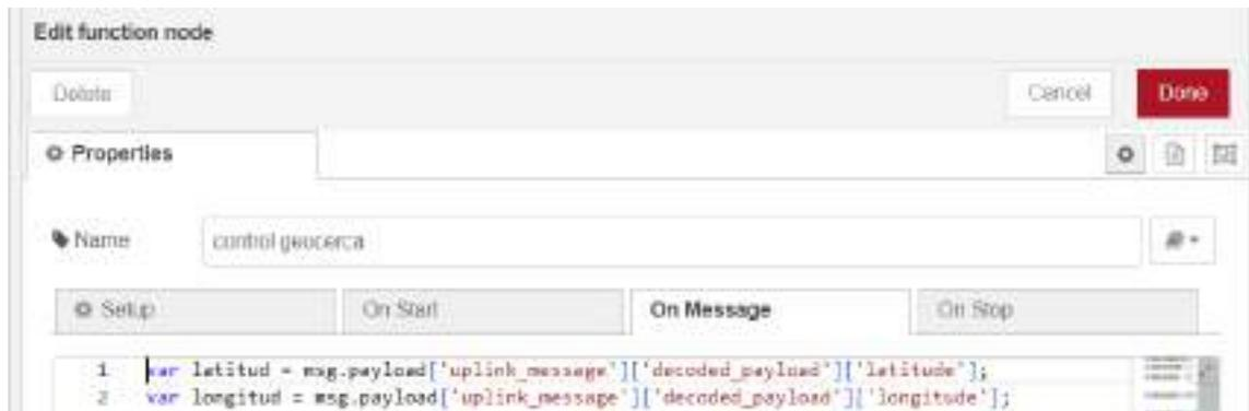
**Ilustración 3-46:** Código para extracción de datos de latitud y longitud enviados desde TTN.
