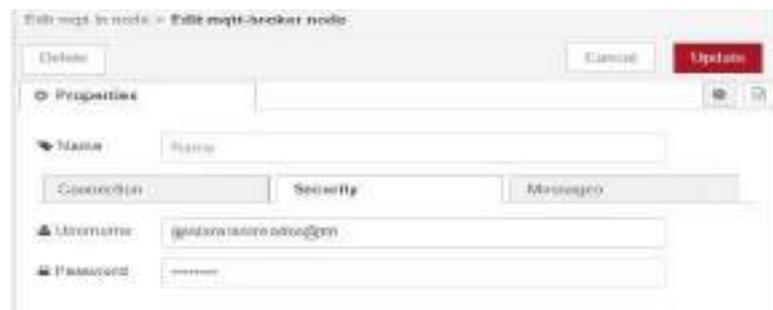
**Ilustración 3-44:** Parámetros de seguridad de MQTT.
