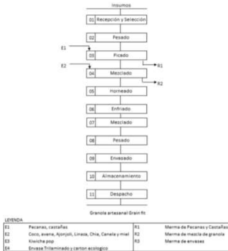
Ilustración 2-4: Diagrama de proceso de elaboración de Granola
