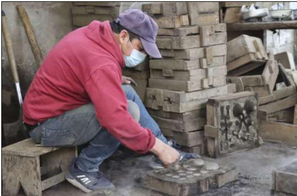
**Ilustración 4-30:** Proceso de fundición en bronce
