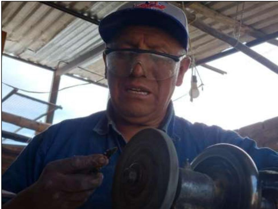
**Ilustración 4-32:** Artesano afilando sus herramientas
